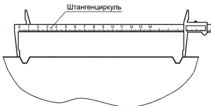
б) на уровне подрельсовой площадки в брусках с подрельсовыми площадками типа III
