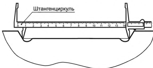
б) на уровне подрельсовой площадки в брусках с подрельсовыми площадками типа III
