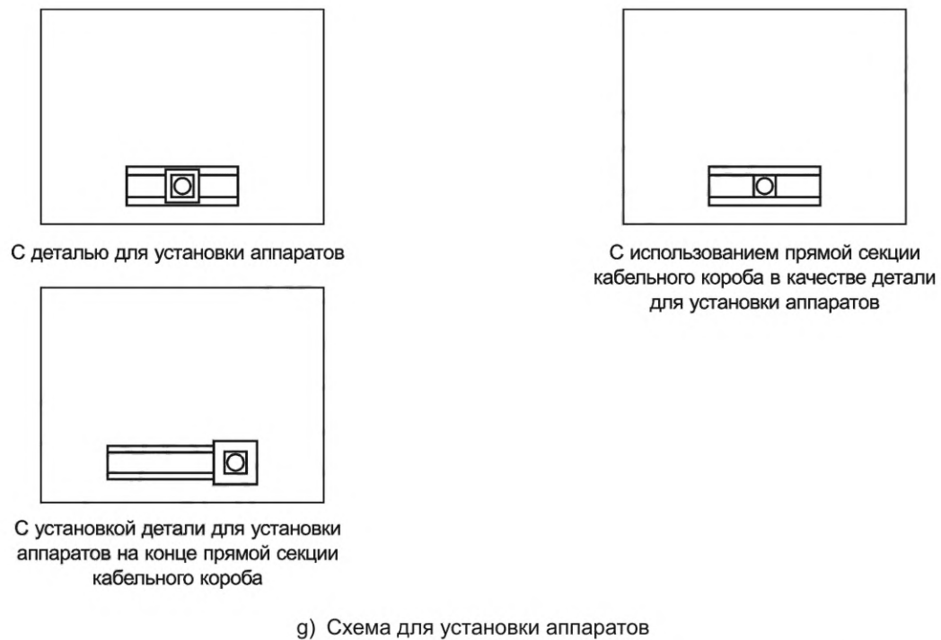
Рисунок 107 — Испытание на воздействие ударов для монтажа и эксплуатации. Примеры организации схемы
