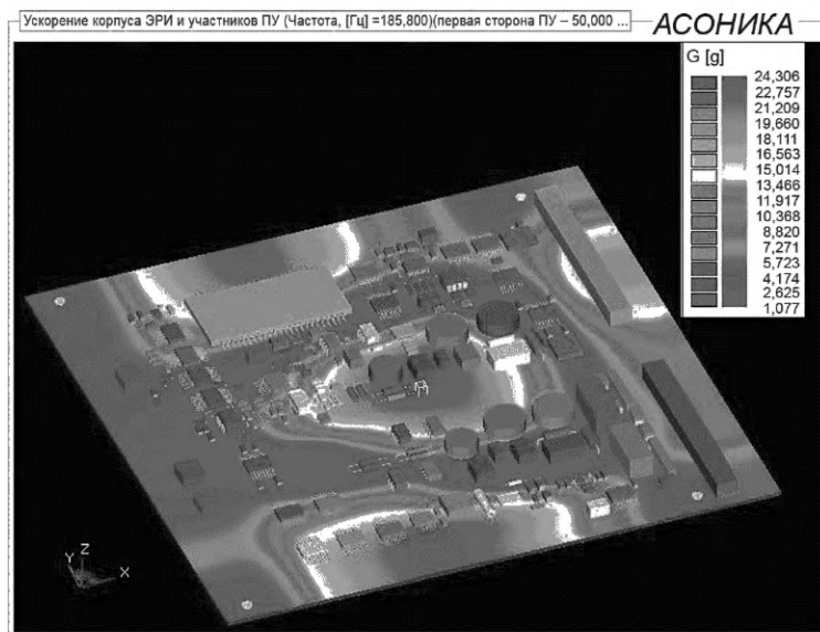
Рисунок Б.3 — Поле виброускорений при воздействии гармонической вибрации на резонансной частоте 186 Гц (в объеме)
