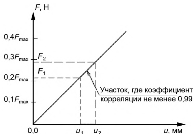
Рисунок 4 — Диаграмма деформирования «нагрузка — деформация» в диапазоне упругой работы материала испытываемого образца
