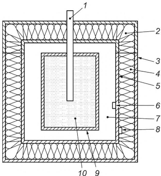
1 — трубка зонда для термометра в диатермической жидкости; 2 — крышка с внешней теплоизоляцией; 3 — внешний кессон; 4 — внешняя теплоизоляция; 5 — внешний корпус калориметрической ячейки; 6 — термометр на внутренней поверхности корпуса; 7 — калориметрическая ячейка; 8 — система кондиционирования воздуха; 9 — форма образца; 10 — испытуемый образец
