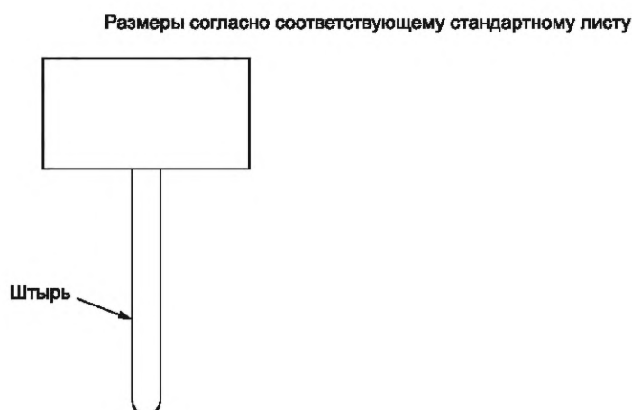
Рисунок 4 — Калибр для определения минимального извлекающего усилия
