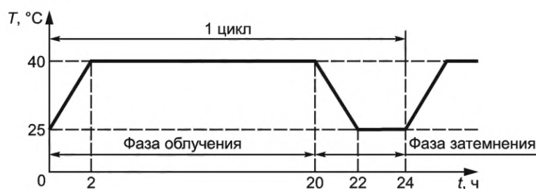
Рисунок 1 — График изменения температуры за один цикл испытаний
