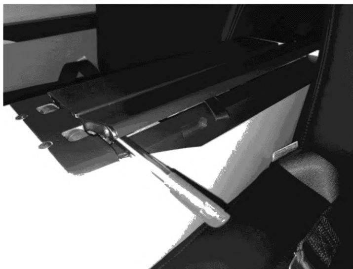
Рисунок Б.1 — Крышка подлокотника кресла со встроенным столиком (пример элемента с оценкой 1а по классификации таблицы 9)
