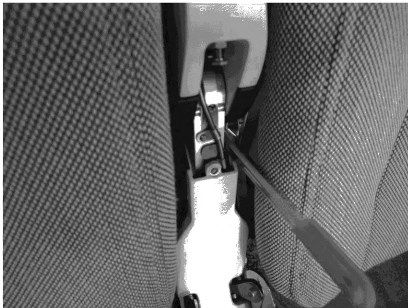
Рисунок Б.3 — Шарнирная точка убирающегося подлокотника кресла (пример элемента с оценкой 2b по классификации таблицы 9)
