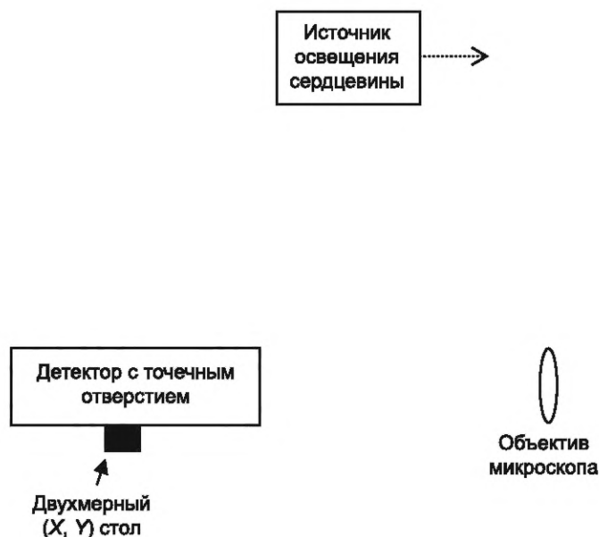
Рисунок В.2 — Типовая схема методики механического сканирования
