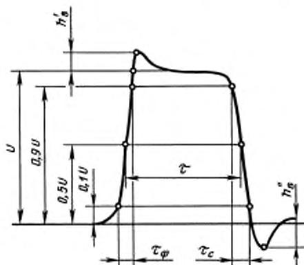
$U$  — амплитуда сигнала;  $\tau$  — активная длительность сигнала;  $\tau_{\phi}$  — активная длительность фронта;  $\tau_c$  — активная длительность среза;  $h_a', h_b''$  — выбросы на вершине и в паузе
