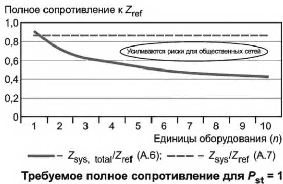
Рисунок А.2 — Визуализация отношения между некоторым количеством оборудования n и P_{st}
