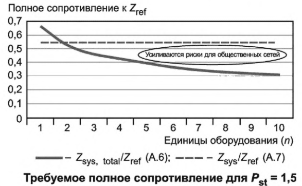
Рисунок А.2 — Визуализация отношения между некоторым количеством оборудования n и P_{st}
