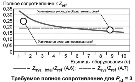
Рисунок А.3 — Требования к полному сопротивлению как функции отдельных значений P_{st@Zref} и степени внедрения n
