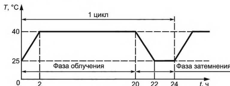
Рисунок 1 — График изменения температуры за один цикл испытаний
