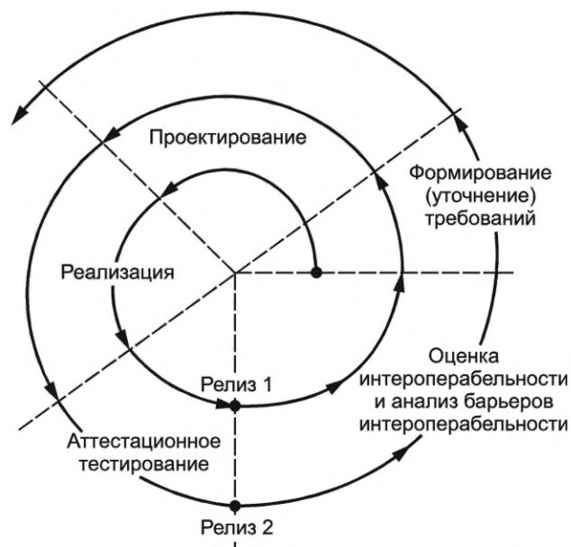
Рисунок 5 — Спиральный (эволюционный) жизненный цикл разработки сложной системы
