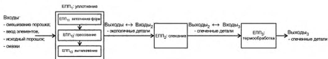
Рисунок 8 — Пример составной системы связанных ЕПП-моделей, иллюстрирующий технологическую линию изготовления изделий методом порошковой металлургии
