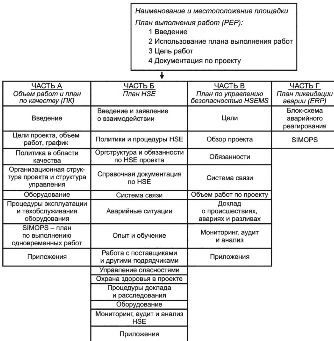
Рисунок А.2 — План выполнения работ (PEP) и его содержание
