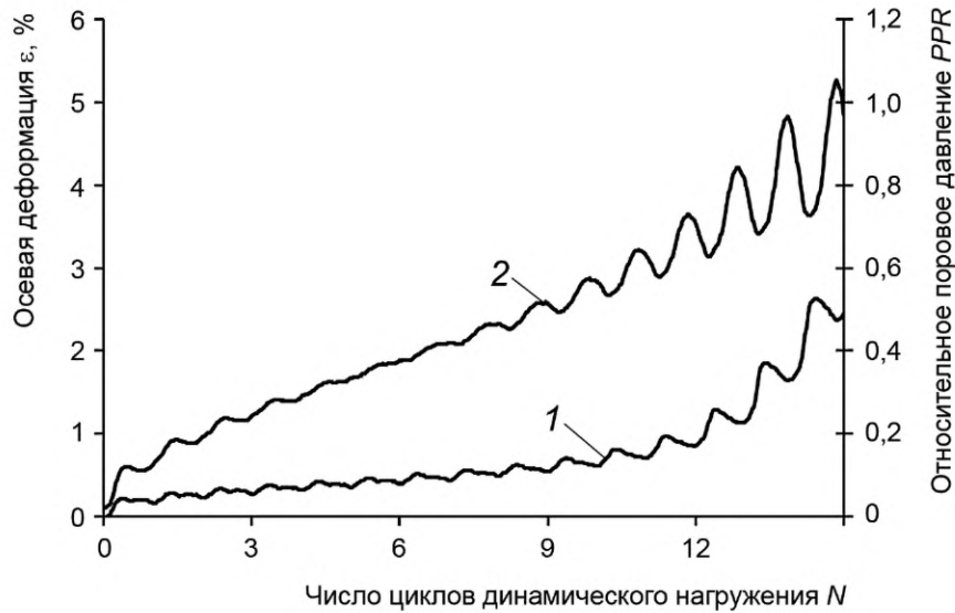
Рисунок Д.1 — График зависимости осевой деформации 1 и относительного порового давления 2 от числа циклов динамического нагружения
