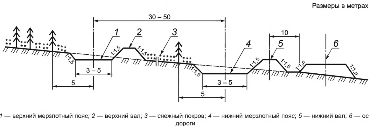
Рисунок 22 — Схема расположения мерзлотных поясов относительно дороги
