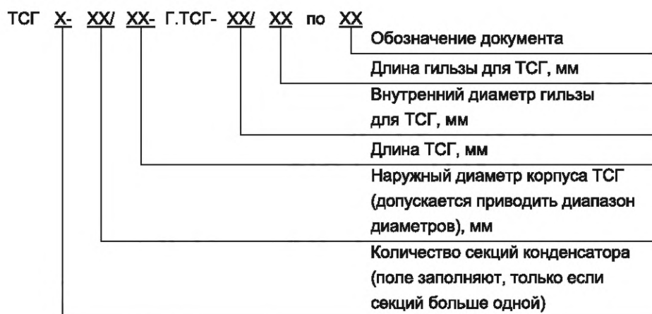
Рисунок 2 — Схема условного обозначения вертикального ТСГ, устанавливаемого в гильзу для ТСГ
