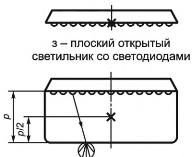
и – плоский с матированным или призматическим рассеивателем светильник со светодиодами
