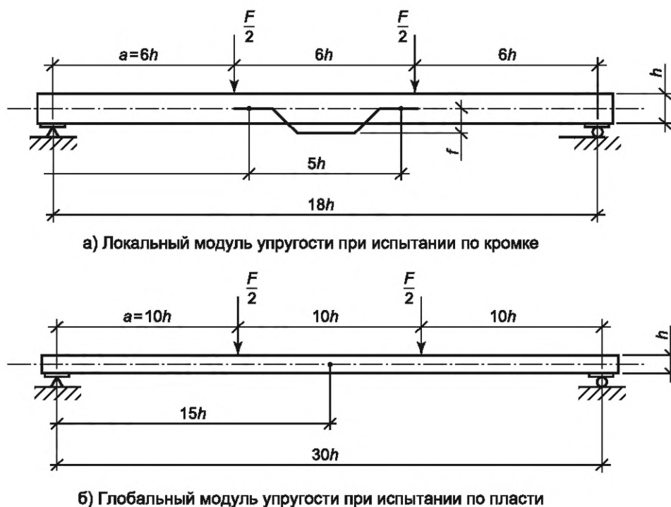
Рисунок А.3 — Схема испытаний образцов ЛВЛ при определении модуля упругости при изгибе
