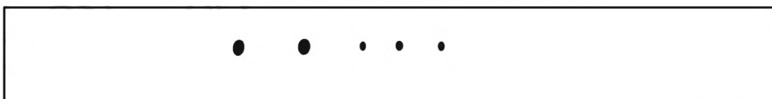
e — пример 5: два несовершенства размером 1,5 мм и три размером 1,0 мм
