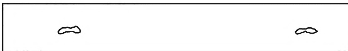
b — пример 2: два несовершенства размером 6,0 мм
