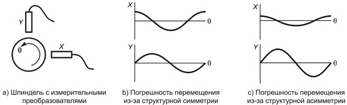
Рисунок А.10 — Погрешность перемещения шпинделя из-за структурной симметрии и структурной асимметрии
