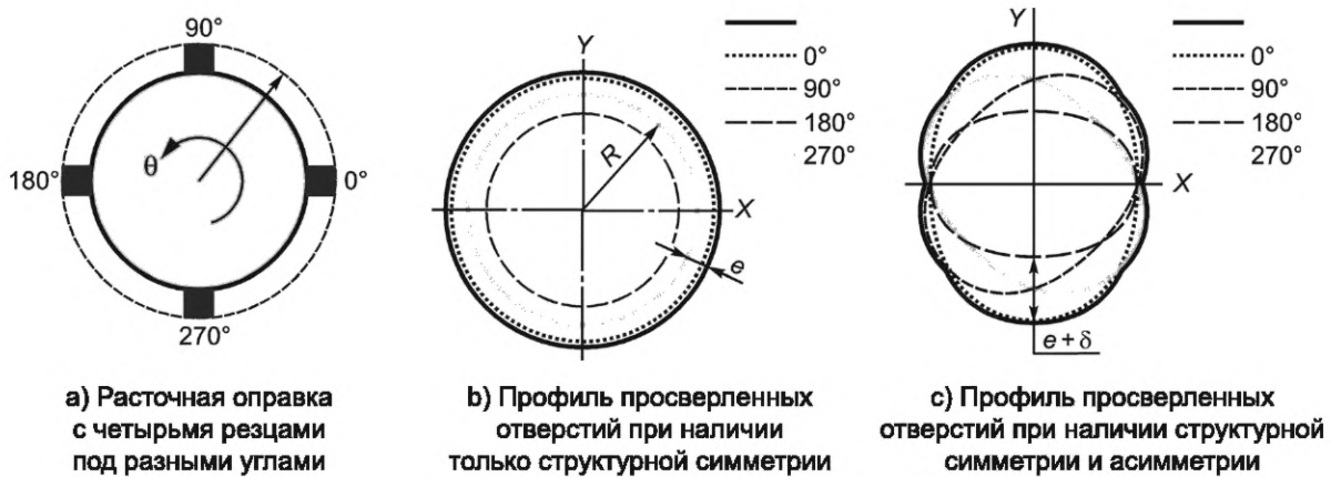
Рисунок А.12 — Профили отверстий для многоинструментальной расточной стержня при наличии структурной симметрии и структурной асимметрии
