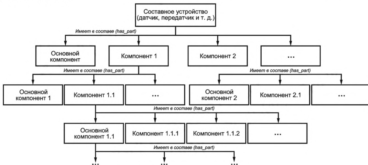
Рисунок 4 — Структура составного устройства
