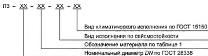
Рисунок 1 — Схема условного обозначения ЛЗ
