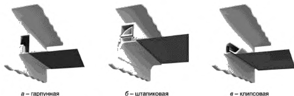
Рисунок 1 — Системы крепления полотна натяжного потолка
