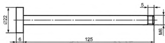
а — выравнивающий стержень для измерительного блока
