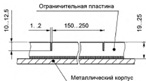
Рисунок 4 — Пазы в ограничительной пластине однослойной футеровки
