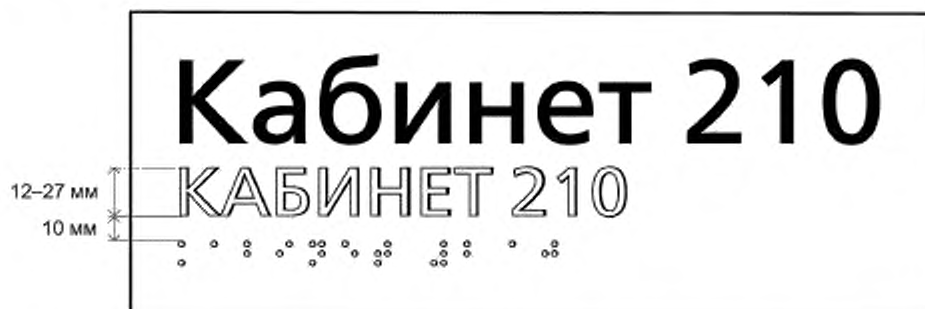
Рисунок 1 — Высота рельефно-линейного шрифта при сочетании с плоско-печатным шрифтом (в данном случае рельефные знаки рекомендуется выполнять прозрачными или в цвет подложки)
