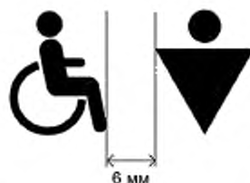
Рисунок 14 — Расстояние между символами различной формы
