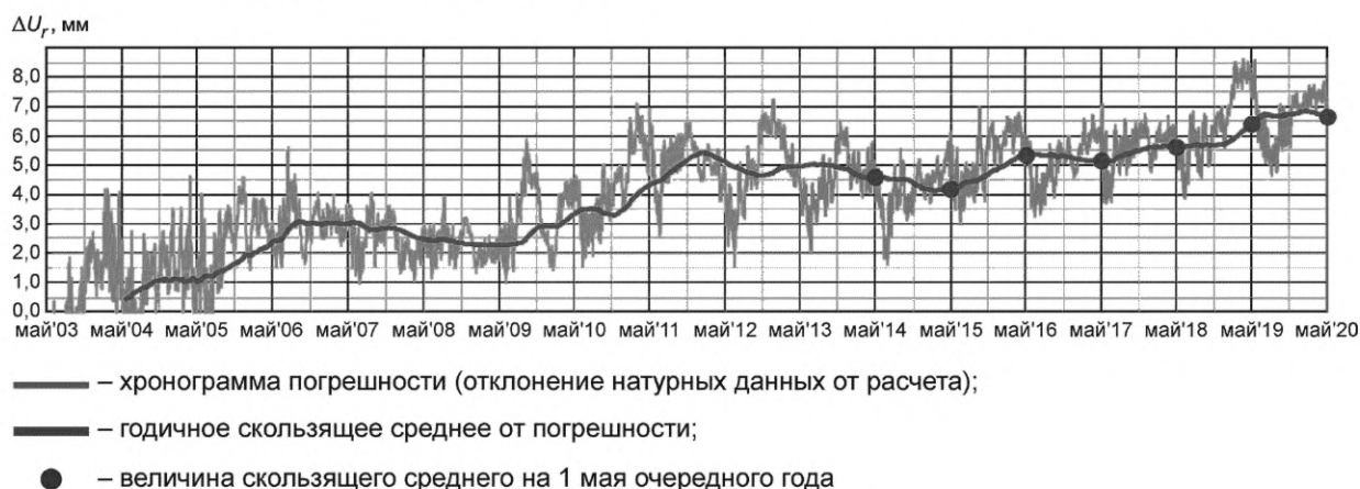
Рисунок Г.1 — Отклонение натуральных данных от расчетных в радиальных перемещениях гребня центральной секции бетонной арочно-гравитационной плотины, мм
