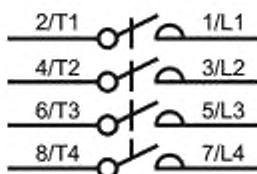
Рисунок А.1 — Клеммы главных цепей
