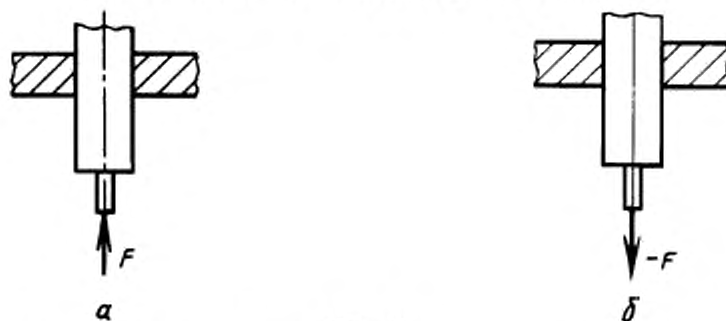
Схема испытания наконечника и его крепления к стержню
