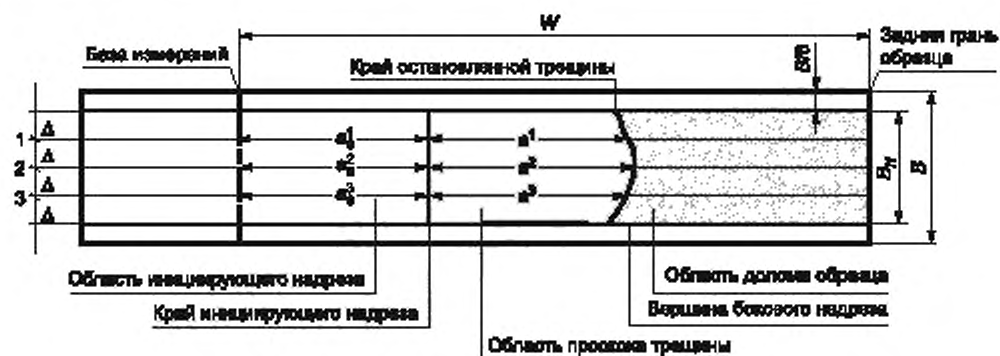
Рисунок Ж.2 — Схема определения длины инициирующего надреза и длины остановленной трещины для образцов типа CCA и DCA
