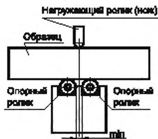
Рисунок 8.1 — Схема нагружения плоского прямоугольного образца без краевой трещины [калибровочного образца типа SE(B)] при испытаниях на трехточечный изгиб
