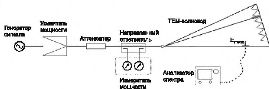
Рисунок E.5.a — Применение монополярной антенны
