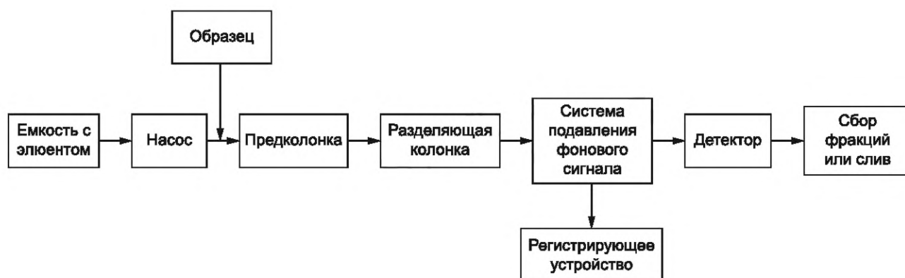
Рисунок 6 — Схема ионного хроматографа
