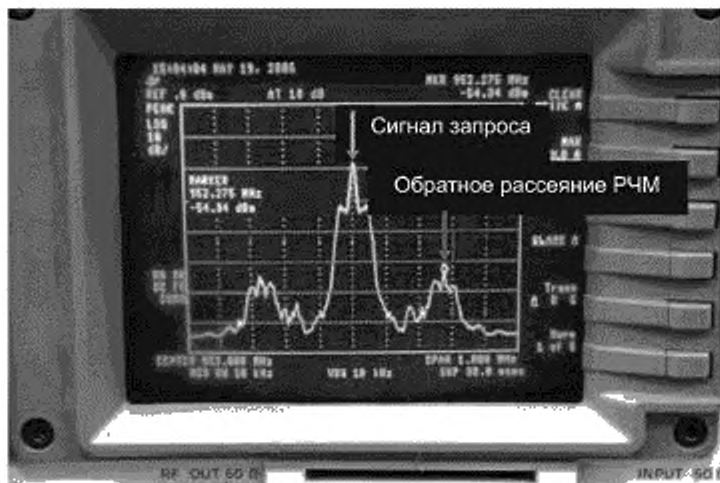
Рисунок 34 — Измерение обратного рассеяния радиочастотной метки
