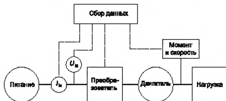
Рисунок 20 — Определение потерь в электроприводе методом вход-выход
