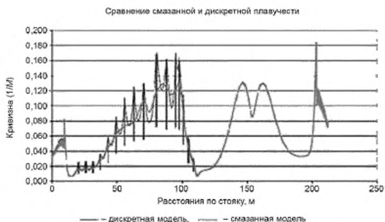
Рисунок 9.8 — Диаграмма распределения кривизны гибкого райзера при применении аппроксимирующего и дискретного подходов
