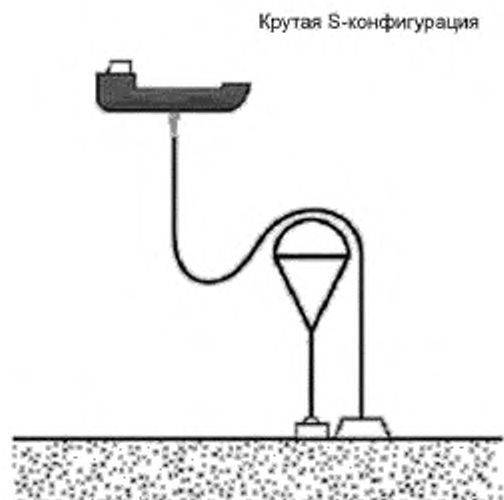
Рисунок 5.16 — Крутая S-конфигурация гибкого трубопровода
