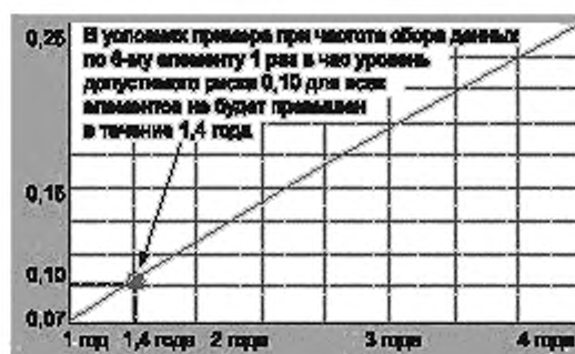
Рисунок Г.3 — Зависимость риска нарушения надежности реализации процесса сопровождения системы от длительности периода прогноза (от 1 до 4 лет)
