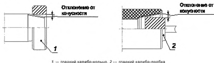
Рисунок 4 — Проверка конусности резьбы гладкими калибрами
