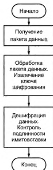
Рисунок 4 — Схема передачи данных от сервера на БНСО
