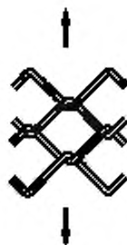
Рисунок Д.3 — Взаимное расположение узлов сплетения сетки габионных конструкций при наибольшем сопротивлении разрушению
