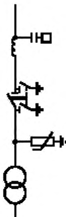
Рисунок 7 — Схема 110-1. Блок (линия—трансформатор) с разъединителем
