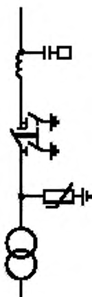
Рисунок 1 — Схема 35-1. Блок (линия—трансформатор) с разъединителем
