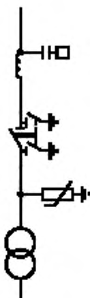
Рисунок 24 — Схема 220-1. Блок (линия—трансформатор) с разъединителем
