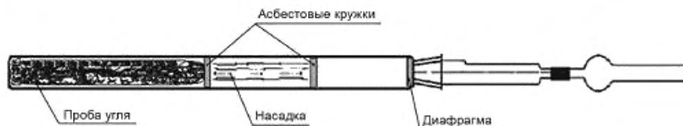
Рисунок 7 — Схема расположения элементов загрузки реакционной трубки для пятисекционной печи и соединения ее с кварцевыми трубками
