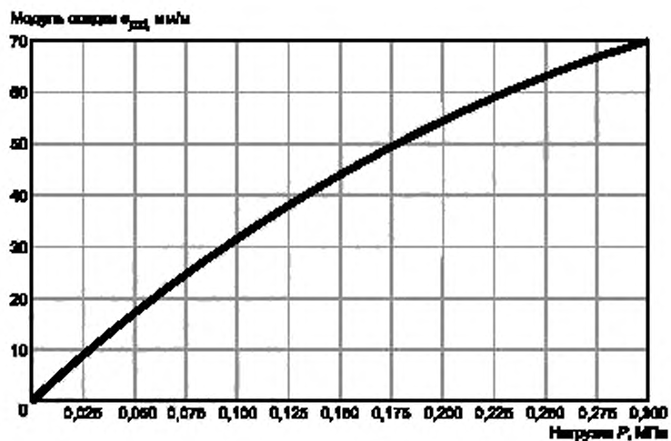
Рисунок А.2 — Компрессионная кривая тиксотропного текучего суглинка
