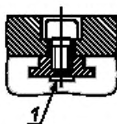
Рисунок D.6 — Правильное расположение гаек и болтов
