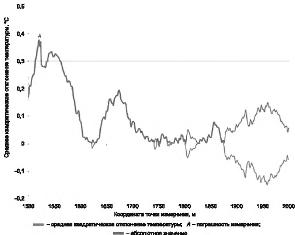
Рисунок 5 — Пример термограммы для расчета погрешности измерения температуры
