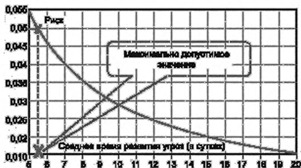
Рисунок Г.6 — Зависимость риска для 3-го выходного результата в течение года от среднего времени развития угроз (от 5 до 20 сут)
