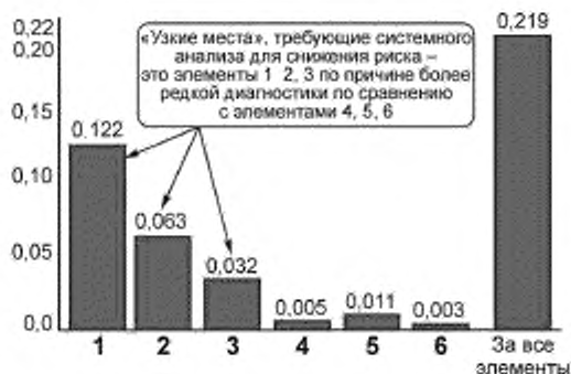
Рисунок Г.7 — Риски нарушения требований по защите информации по элементам 1—6 и за все элементы в течение 2 лет при ежесуточном контроле состояния объектов инженерной инфраструктуры ЦОД
