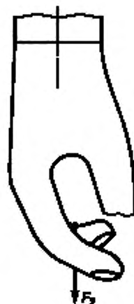
Рисунок 4 — Схема испытания фиксатора пальцев
