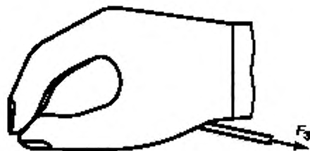
Рисунок 5 — Схема испытания механизма раскрытия пальцев кисти
