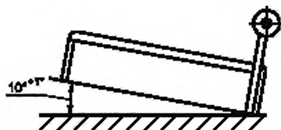
Рисунок 3 — Испытание скамьи на устойчивость в продольном направлении
